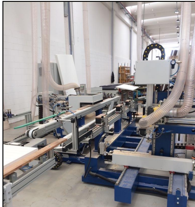
Isola di produzione automatica per porte installata nel nuovo stabilimento
