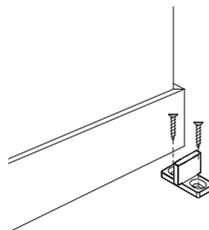
4. posizionare il nasello guida in asse con il binario superiore di scorrimento del carrello. Forare il pavimento e fissare il nasello con il tassello e le viti in dotazione.
