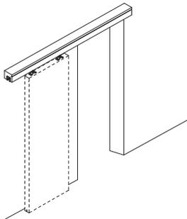
3. determinare la posizione del travetto con il pannello porta agganciato. Quindi fissare il travetto alla parete con i tasselli e le viti in dotazione tenendo conto della posizione del montante di battuta.
